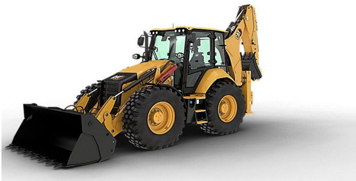
Obr. č. -6 Rýpadlo – nakladač CATERPILLAR 444
